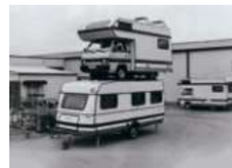
Der innovative PUAL-Aufbau wird entwickelt und stellt seine Stabilität unter Beweis.
