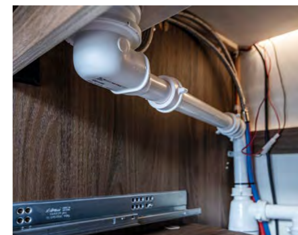
La gamma New Deal dispone dell'esclusivo scarico rigido per l'acqua di recupero, raccolta tramite un sifone dotato di un sistema di tubature antiodore in un serbatoio appositamente concepito.
